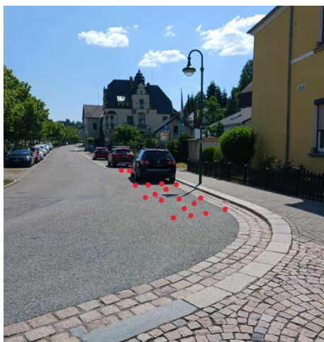
Markierung Lindenstraße 1, Kurvenbereich bei Einfahrt KITA (neu). Der Bereich ist auf Grund der Einfahrt KITA / Abbiegung auf die Hauptstraße sehr eng und unübersichtlich. Durch die Markierung wird in dem Bereich mehr Platz geschaffen und das Unfallrisiko minimiert.
